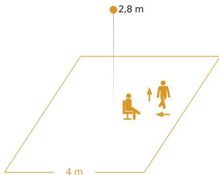
Possibile altezza di montaggio: 2,50 m – 4,00 m
